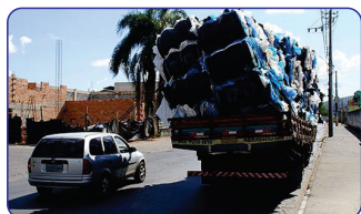
Carga em excesso
